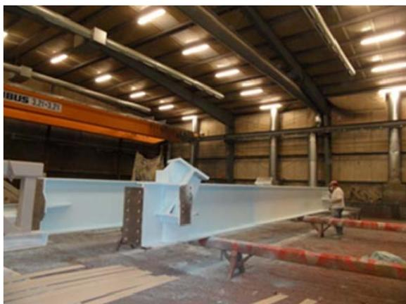
写真⑤ 鉄骨工場内での塗装状況
